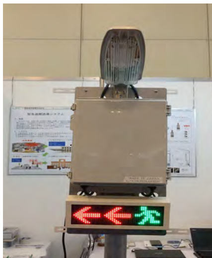
緊急避難誘導システム
